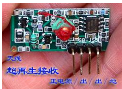
超再生接收模块的体积：30x13x8 毫米
