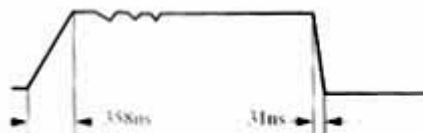
图3 Q的导通时间和关断时间
